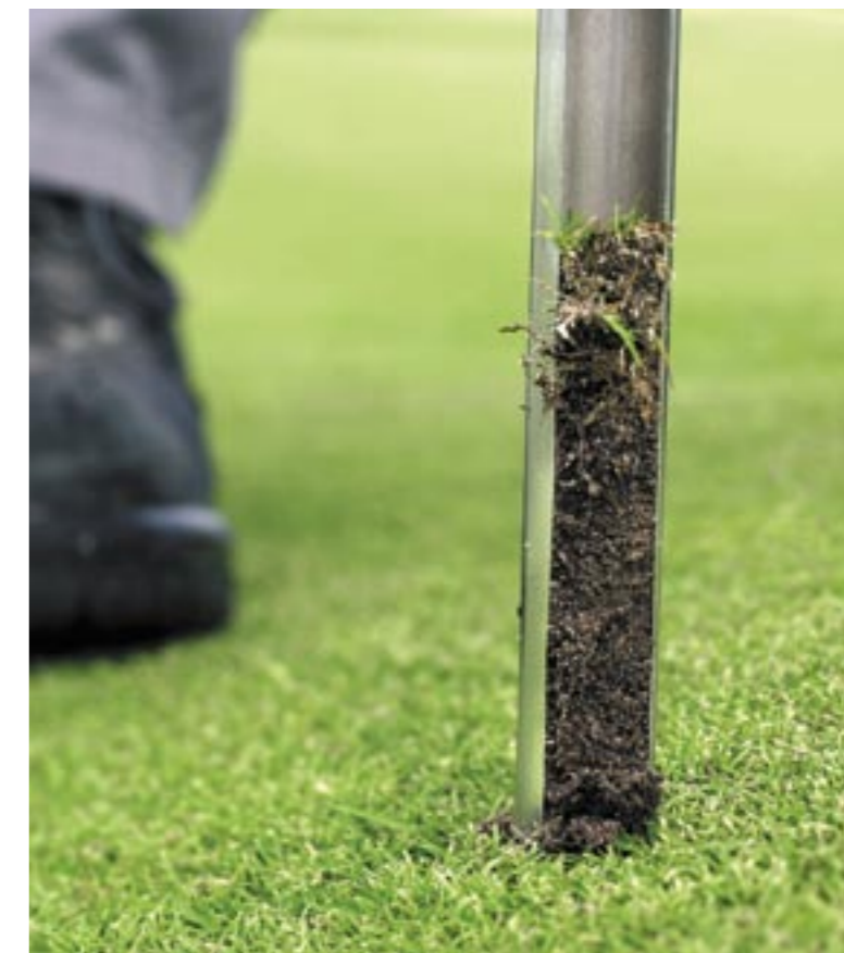
Met een grondboor wordt een monster van de bodem genomen. Dit monster gaat voor onderzoek naar het laboratorium.
